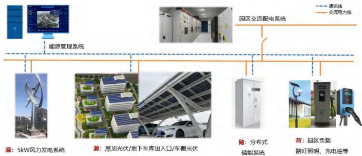
图 3-13 某产业园源网荷储协同项目
